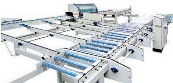
Troncatrice a spintore con sistema di scarico automatico a pinze.
